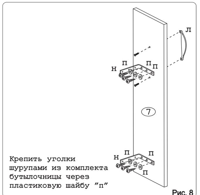
Крепить уголки шурупами из комплекта бутылочницы через пластиковую шайбу "п"
